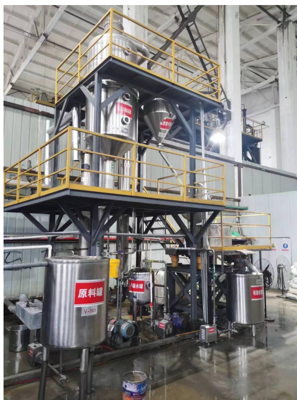
含盐废水单效蒸发结晶系统
