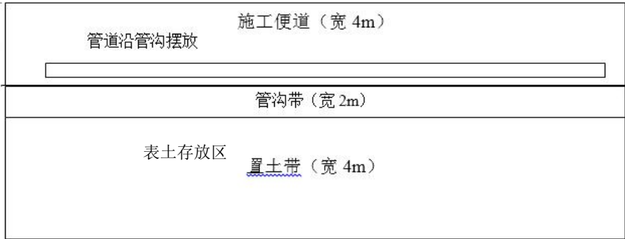
图 3.8-3 管道开挖施工平面布置示意图
