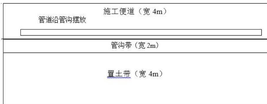
图 3.6-3 管道开挖施工平面布置示意图
