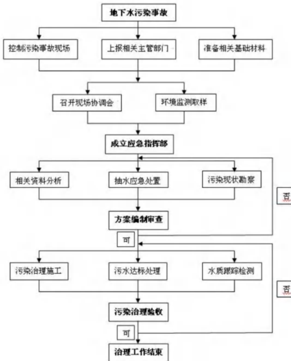
图 6-2-2 地下水污染应急治理程序框图
