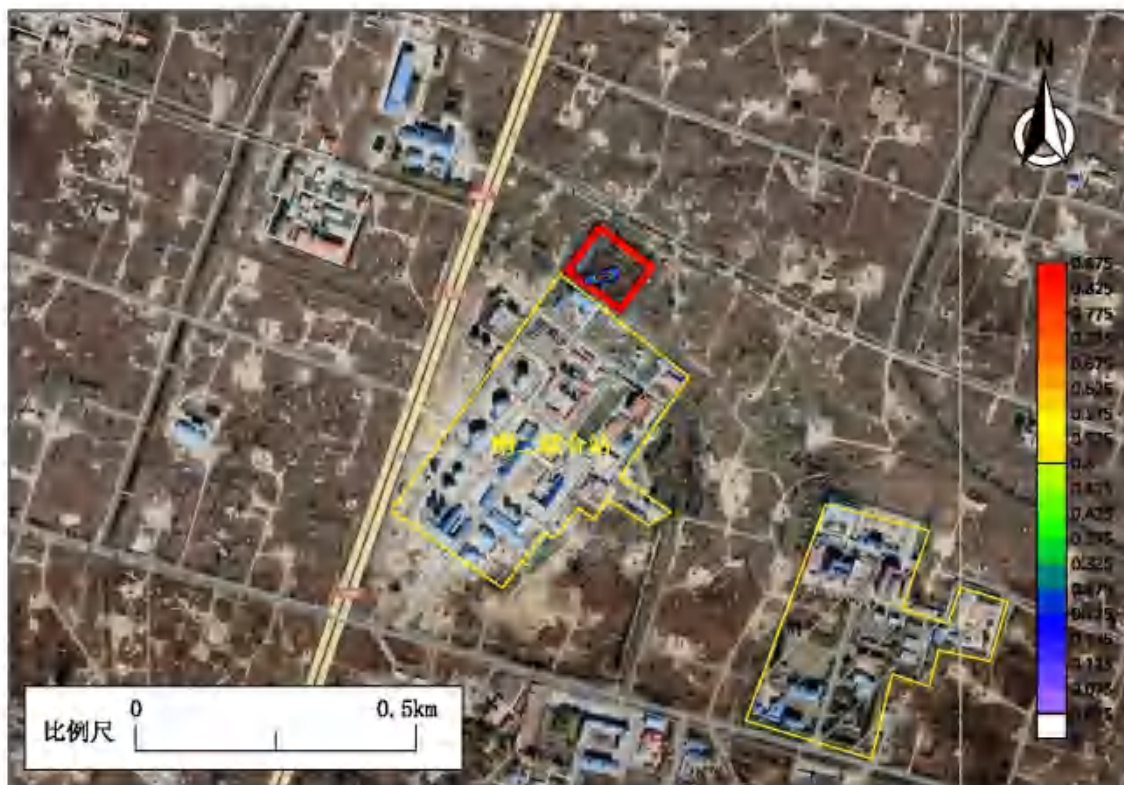
图 5-2-4 氨氮 100 天运移预测结果（浓度 >0.025\text{mg/L} ）
