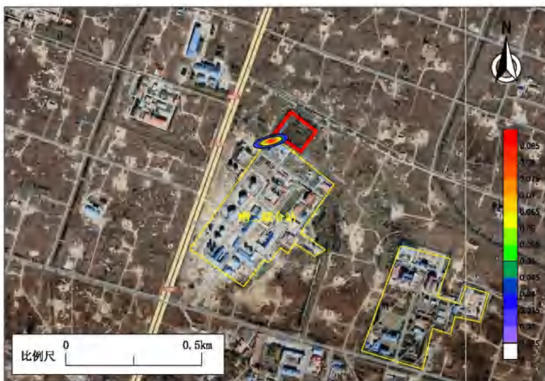
图 5-2-4 氨氮 100 天运移预测结果（浓度 >0.025\text{mg/L} ）
