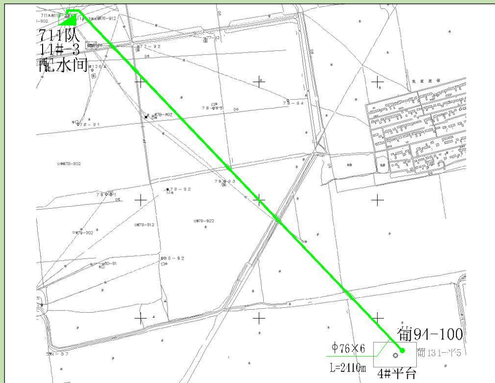
图 3.5-6 葡 94-100 单井注水管线走向示意图
