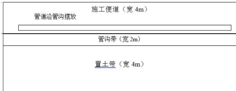
图 3.2.4 管道开挖施工平面布置示意图
