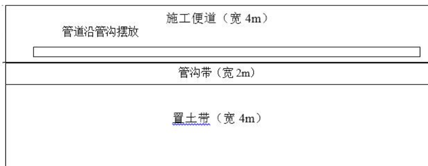
图 3.8-3 管道开挖施工平面布置示意图
