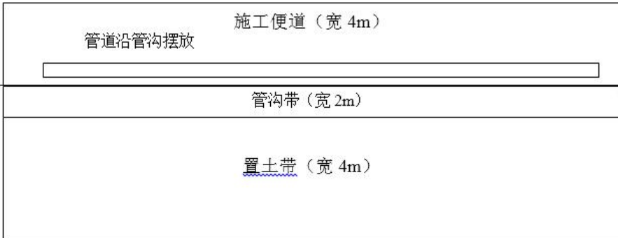
图 3.8-2 管道施工作业断面图
