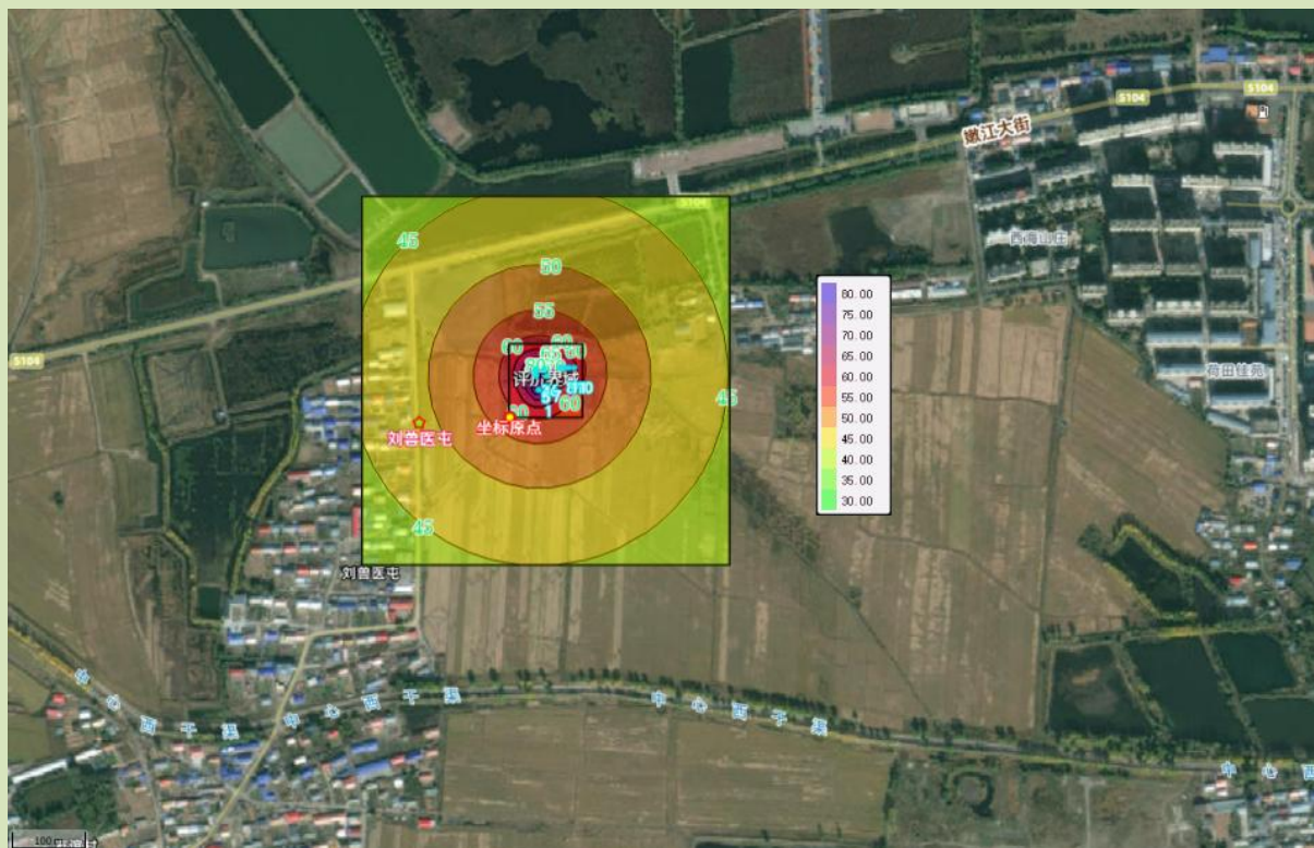
图 5.4-1 钻井工程噪声贡献值预测图
