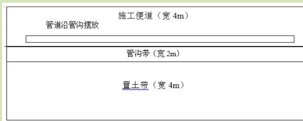
图 3.8- 3 管道开挖施工平面布置示意图
