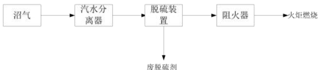
图 6.2-2 沼气利用流程及产污环节图
