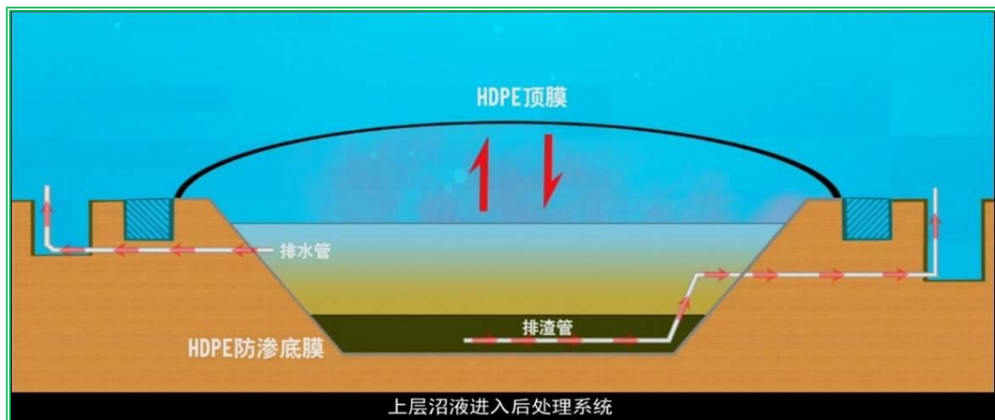
图 6.2-2 黑膜厌氧池平面布置图
