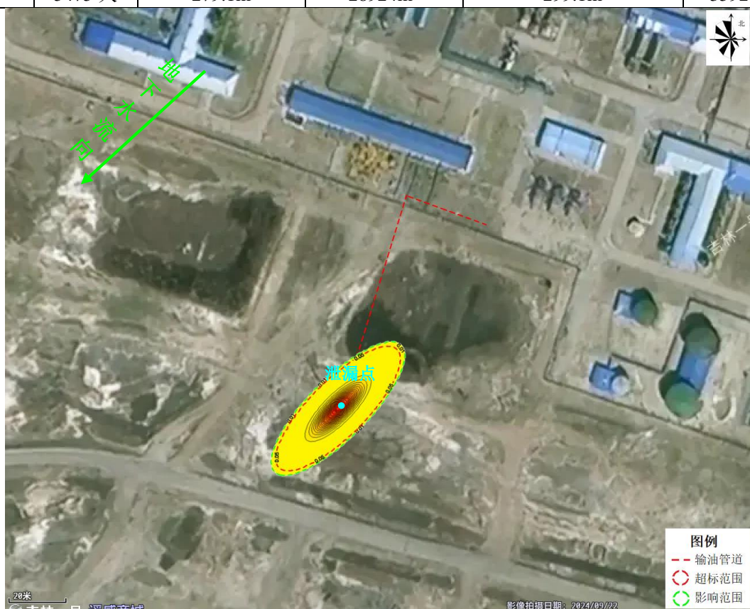
图 5.3-4 输油管道全管径泄漏后 100 天污染物浓度分布图（污染源点：0，0）
