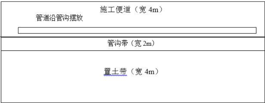
图 3.8-2 管道施工作业断面图
