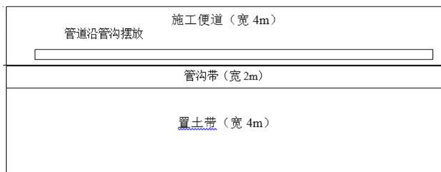
图 3.6-4 管道开挖施工平面布置示意图
