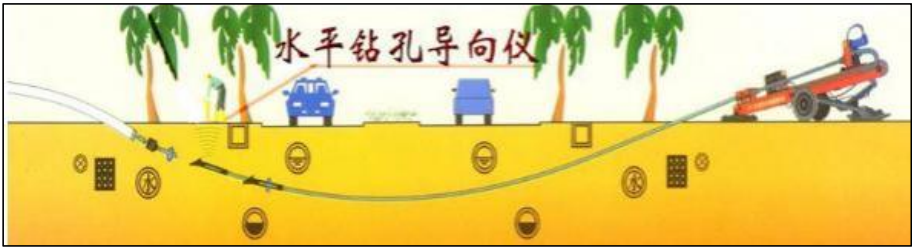
图 3.6-5 定向钻穿越施工示意图
