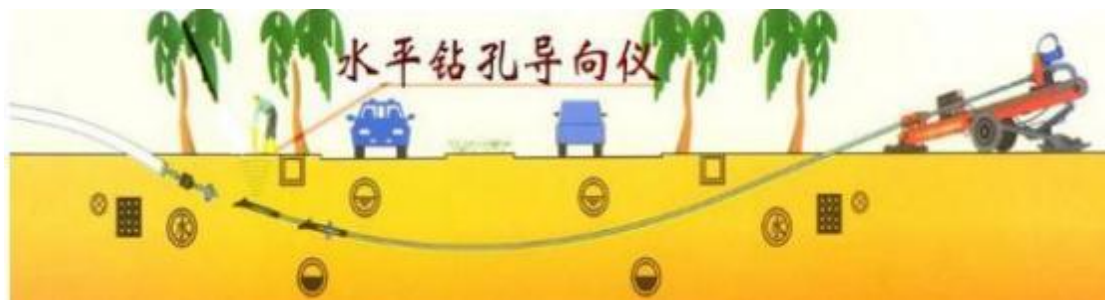
图 3.7-3 定向钻施工示意图
