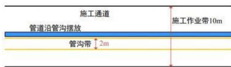
图 3.5-1 (2) 管道施工平面布置图
