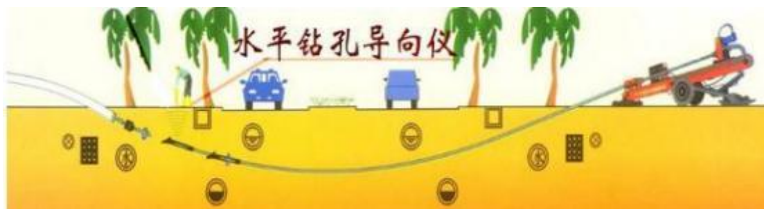
图 3.7-3 定向钻施工示意图
