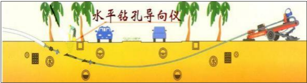
图 3.8-6 定向钻穿越施工示意图
